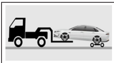
یدک‌کشی از سمت جلو با استفاده از یدک‌کش بلندکننده چرخ
