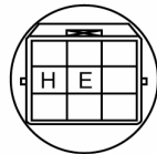
کانکتور دسته سیم گیربکس (دید از سمت سیم کشی)
