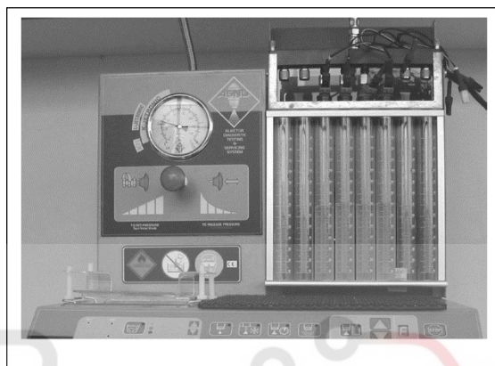
تصویر ۹-۱-۶ دستگاه تست و شستشوی انژکتور سوخت
