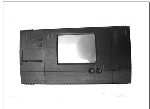
تصویر ۹-۱-۱ دستگاه عیب‌یابی با استاندارد OBD مربوط به سیستم سوخت‌رسانی انژکتوری
