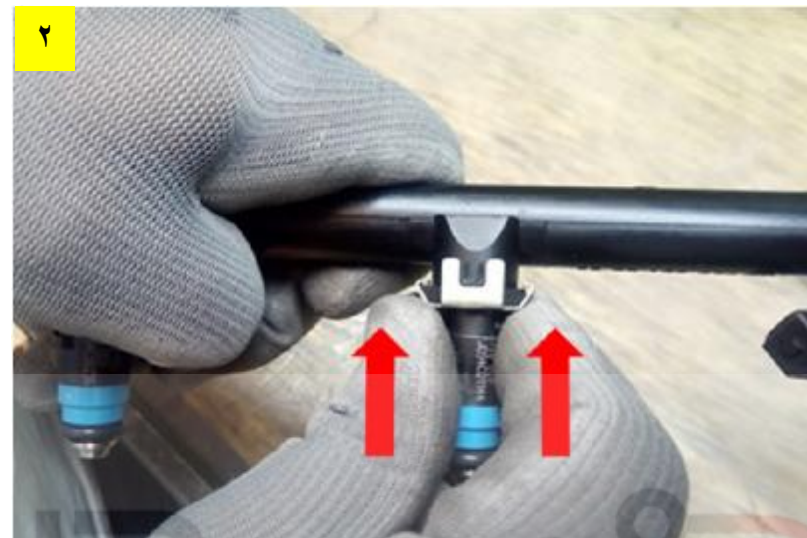
قرار دادن خار نگهدارنده در جای خود با فشار دادن انژکتور به طور مستقیم به سمت ریل سوخت (مطابق با تصویر)
