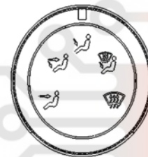
(کلید کنترل مسیر توزیع هوا)
