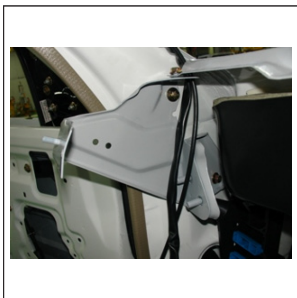
نصب براکت های داشبورد روی ستون (چپ و راست) توسط ۴ عدد پیچ پایه داشبورد
