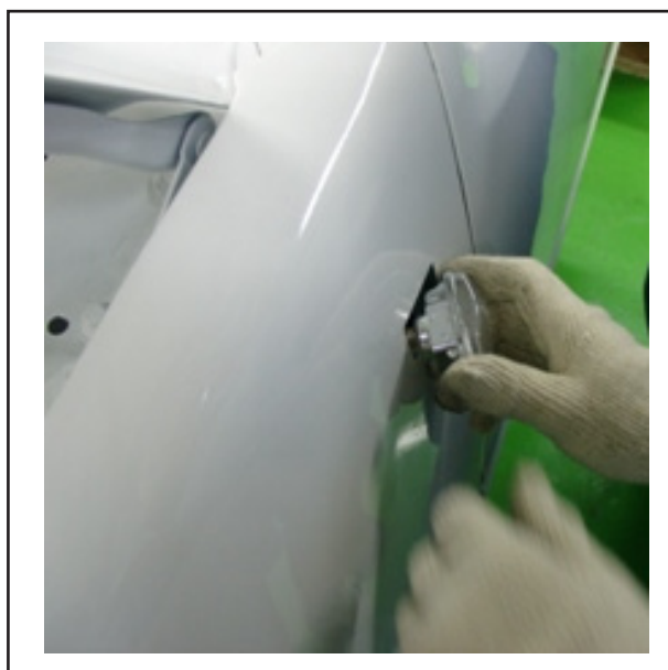
جا زدن سوکت چراغ راهنما بغل به سوکت دسته سیم و جا زدن چراغ (سمت چپ و راست)
