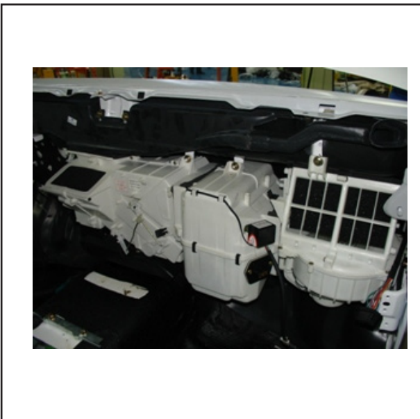
درپوش قطعه بخاری را برداشته در محل مورد خود جا می زنیم و توسط دو عدد مهره و واشر از دو طرف چپ و راست می بندیم.
