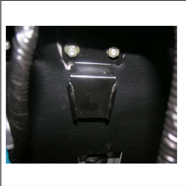
نصب دیاق نگه دارنده کنیستر داخل محفظه موتور روی سینی جلو پا توسط ۳ عدد مهره
