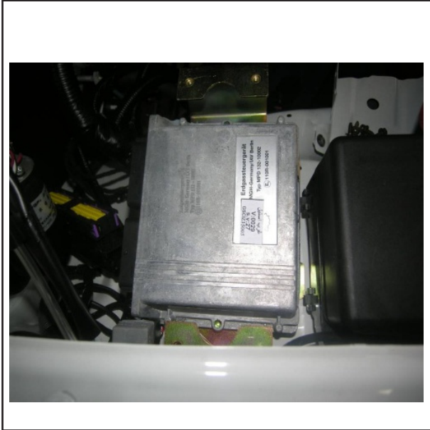
نصب ECU گاز روی براکت توسط دو عدد پیچ M6 و اتصال کانکشن مربوطه راست (سمت شاگرد) توسط ۴ عدد پیچ M6
