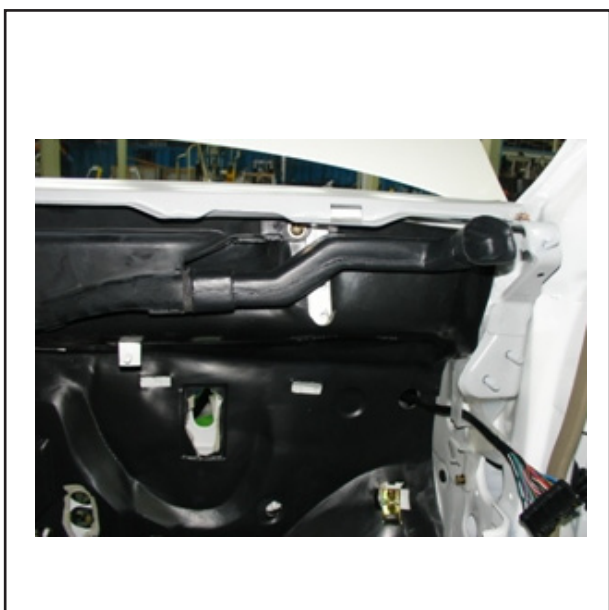
جا زدن قطعه کانال هوای شیشه جلو در محل داشبورد توسط ۴ عدد پیچ خودکار
