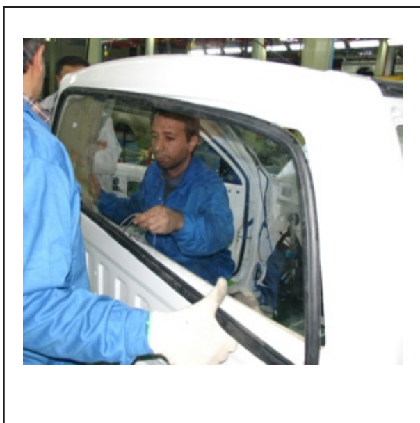
قرار دادن نوار لاستیکی دور شیشه عقب و عبور دادن طناب از لای نوار شیشه و زدن مایع روی نوار لاستیکی جهت خوب جا رفتن شیشه
