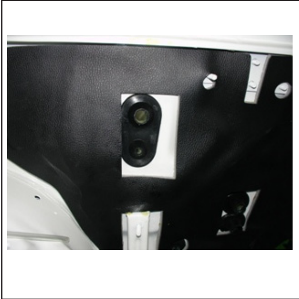
جا زدن واشر آب بندی لوله های اواپراتور در محل خود داخل محفظه مطابق شکل
