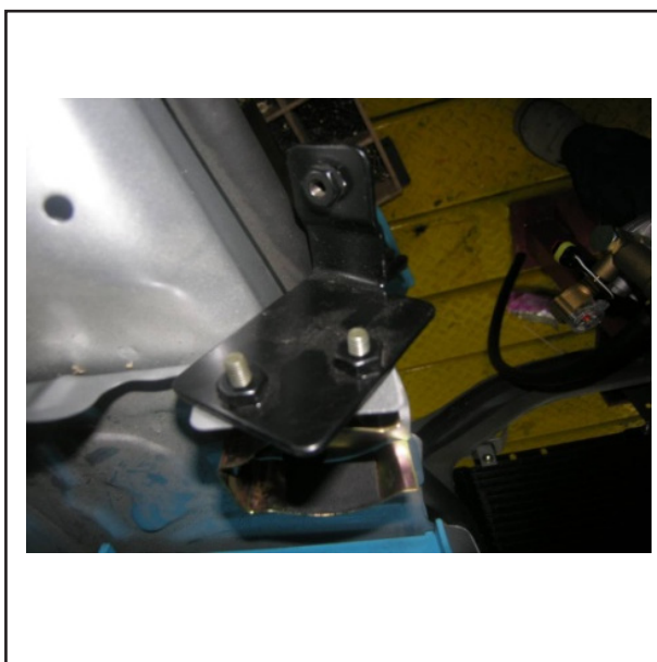
نصب نگه دارنده فیلتر بنزین روی دیاق پایه فیلتر با یک عدد پیچ نصب براکت فیلتر بنزین بر روی دیاق پایه فیلتر
