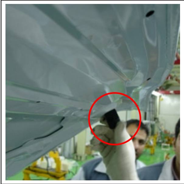
قرار دادن ضربگیر لاستیکی روی بدنه درب کاپوت (دو طرف درب موتور) با پیچاندن آن
