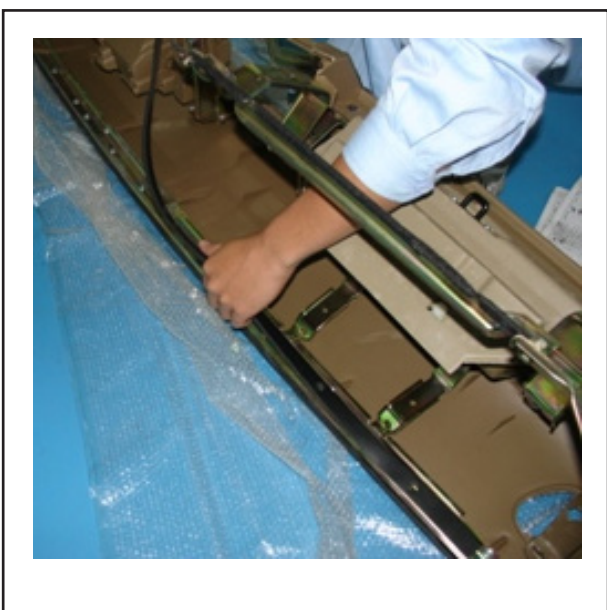
چسباندن نوار جهت آب بندی در قسمت مربوطه اسکلت داشبورد
