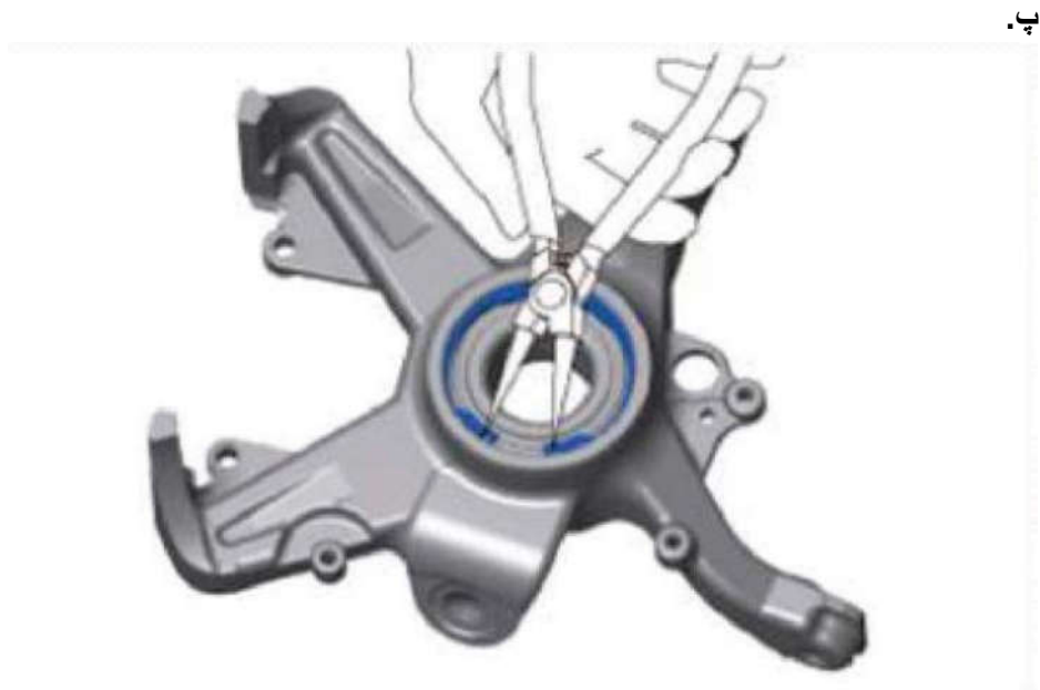
بست حلقه ای سوراخ را با انبر بست جمع کن باز کنید.
