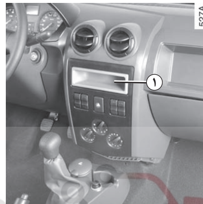
۱ محل نصب سیستم صوتی
